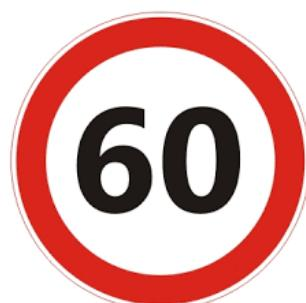
В связи с этим на задней части кузова слева у автобуса также должен быть установлен опознавательный знак "Ограничение скорости" - в виде уменьшенного цветного изображения дорожного знака 3.24 с указанием разрешенной скорости "60 км~ч" (диаметр знака - не менее 160 мм, ширина каймы - 1/10 диаметра).
